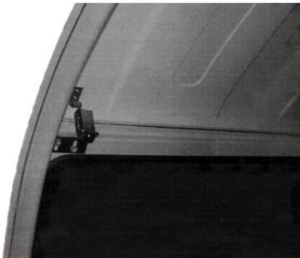
6) Photo intérieure de la fermeture de la partie AV à l'aide de grenouillères sur le montant de pare brise.
