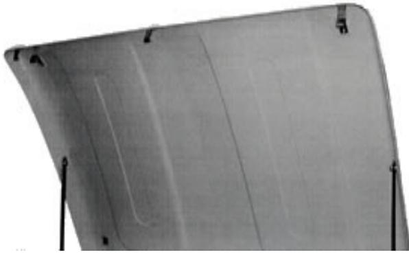
7) Vue de la partie AV ouverte, pour situer la position des 3 crochets non montés sur celle-ci (crochets permettant le blocage à l'aide des 3 grenouillères (voir photo 4 en position ouverte).
