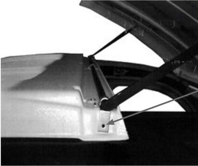
4) La partie centrale AV doit tout simplement être percée à l'aide d'un forêt de diamètre 5,2 jusque dans la caisse. Utiliser le rivet de diamètre 5 pour la fixation de l'ensemble (partie centrale AV) + arceau. Une bande de joint mousse doit être collée sur toute zone de contact des deux pièces.
