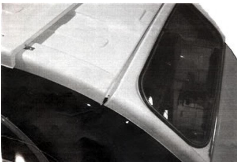
3) Positionner la partie centrale du HARD TOP, par dessus la lunette AR (voir photo). Amener celle -ci en butée sur l'angle, si possible mettre un morceau de joint mousse avant de procéder au perçage des 2 côtés pour le blocage des 2 pièces.
