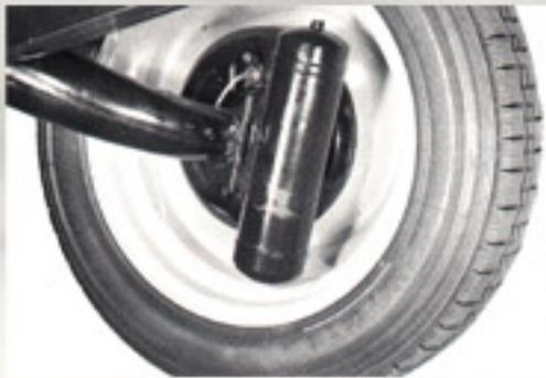
Hängende Radbremszylinder der Hinterachse machen sich durch entsprechende Geräusche regelmäßig bemerkbar.
