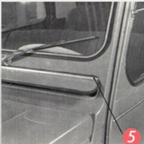
Rostgefährdet hoch drei: Schäden am Scheibenrahmen und Haubenscharnier ziehen umfangreiche Reparaturen nach sich, während die Lüfterklappe leicht zu wechseln, dann aber meist undicht ist.
